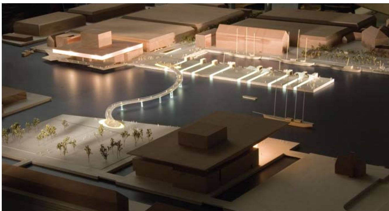
Den nye bro slanger sig over havnen for at blive lang nok til at løfte sig 5,5 meter over vandet uden at blive for stejl.
